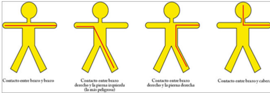
Imagen 2. Principales trayectorias de la corriente eléctrica sobre el cuerpo humano
